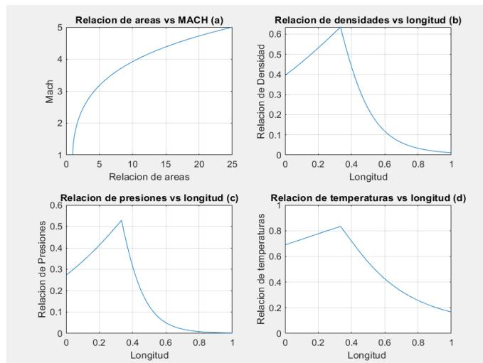
**Figura 1.** Comportamiento aerotermodinámico del flujo a través de una tobera convergente-divergente.
